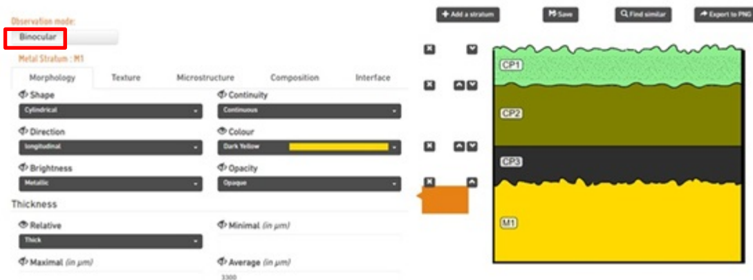
Stratigraphie numérique de la structure de corrosion observée sous binoculaire.
